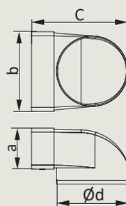
**Соединители плоских воздуховодов с выходом на фланцевые воздухораспределители**
